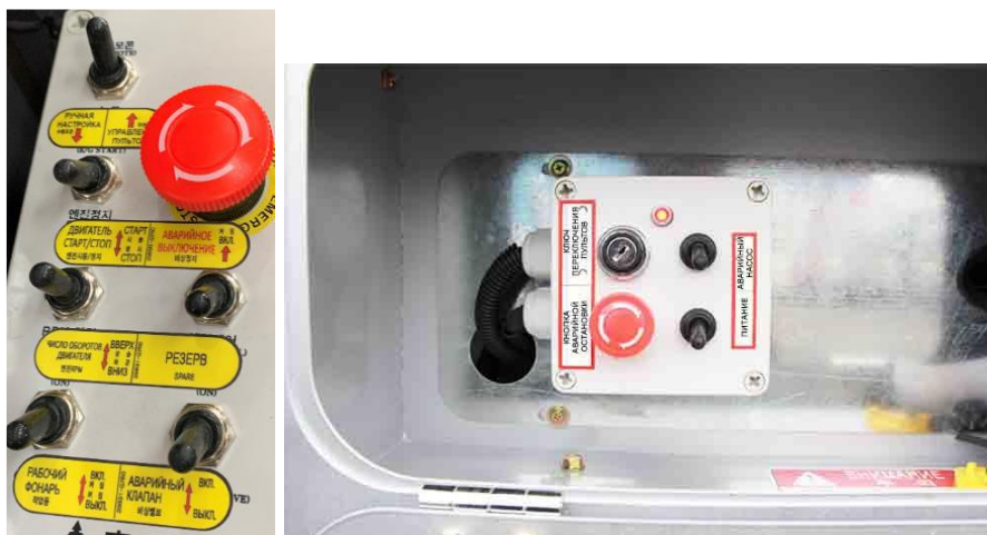
Рисунок 4.5 – Пример расположения кнопки аварийной остановки на пультах управления
