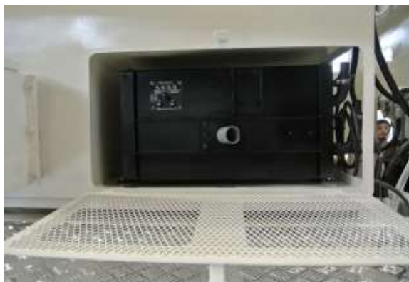
Автономный дизельный обогреватель водяного бака
