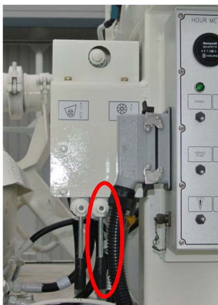
Рычаг подачи воды (справа от бункера)
